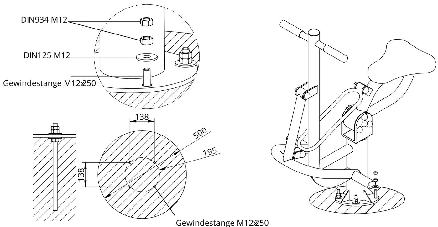
3. Bringen Sie die Abdeckkappe am Fuß des Trägers an, so dass Montageplatte und Schrauben verdeckt werdend.
