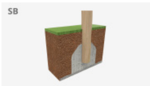
Befestigung eines Holzträgers in einer Rasenfläche
